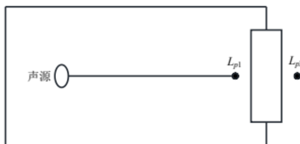
图 4-4 室内声源等效为室外声源图例
