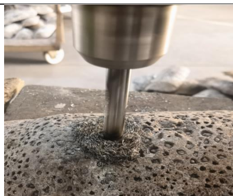
图 2-3 钻屑操作示例图
