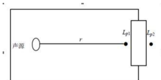
图 4-1 室内声源等效为室外声源图例
